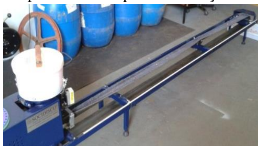
Figura 2. Esteira de plantabilidade para distribuição das sementes
